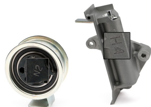
Afbeelding 2: Spanrol 531 0436 20 met trillingsdemper 533 0035 10
